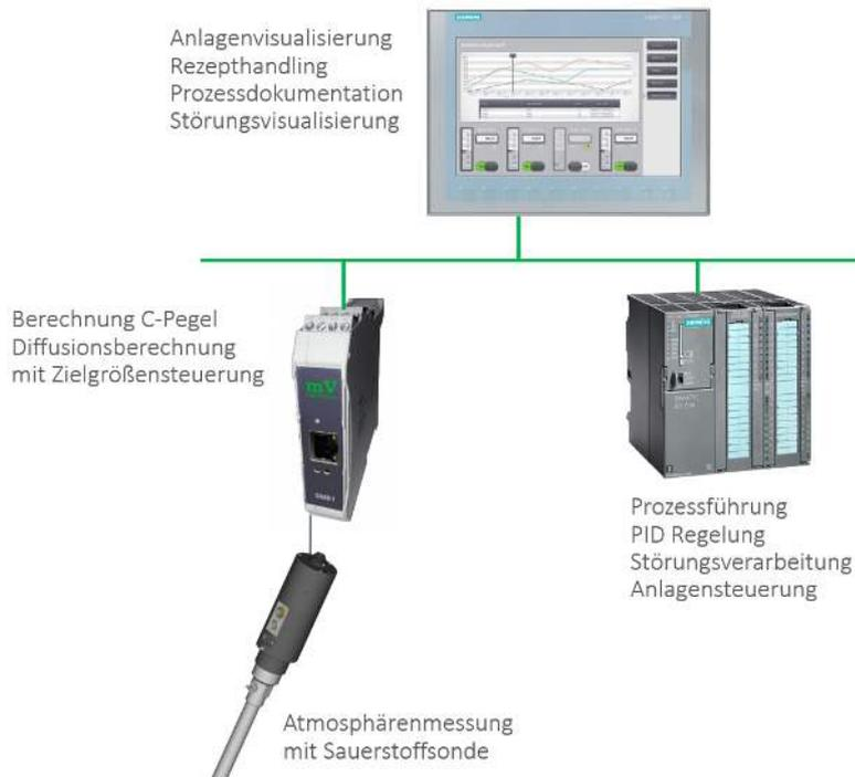
Die Anlagenvisualisierung, Editieren der Rezepte, die Prozessdokumentation und die Störungsvisualisierung werden auf dem Bedienpanel zur Verfügung gestellt .
