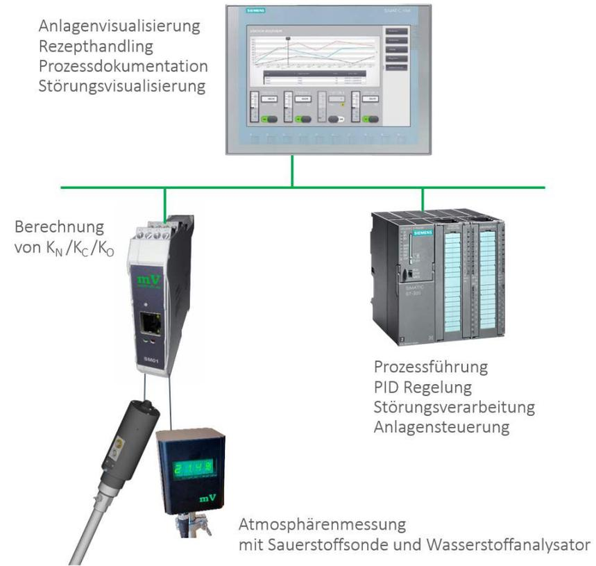
Die Anlagenvisualisierung, Editieren der Rezepte, die Prozessdokumentation und die Störungsvisualisierung werden auf dem Bedienpanel zur Verfügung gestellt.
