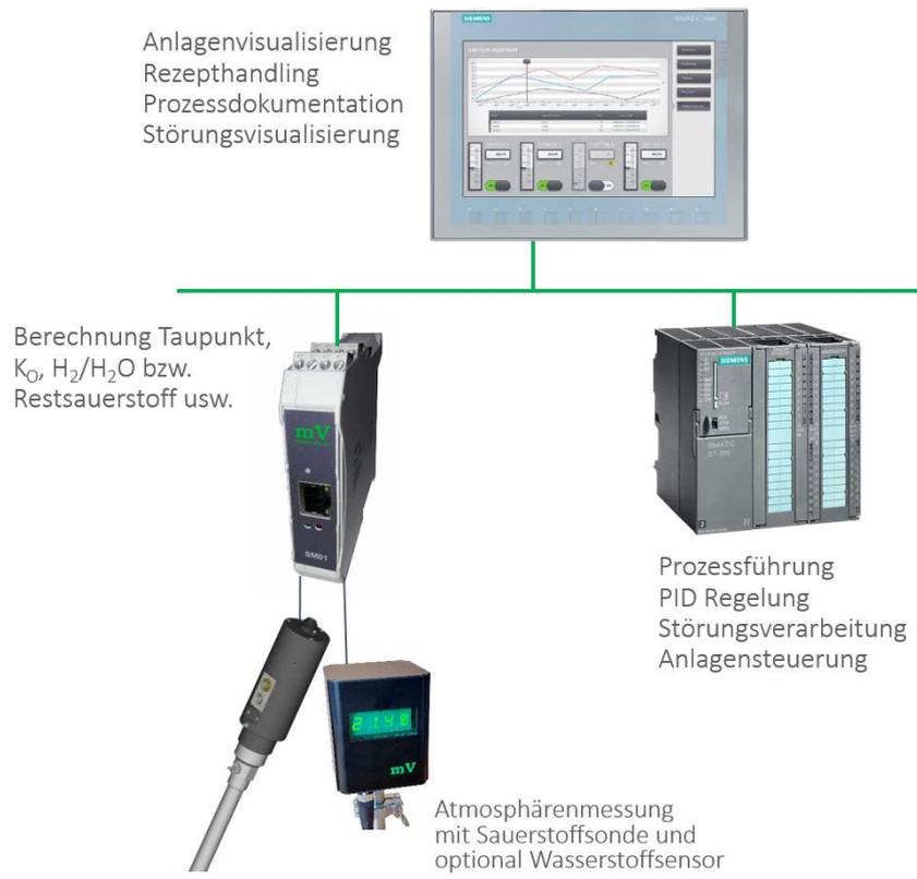
Die Anlagensvisualisierung, Editieren der Rezepte, die Prozessdokumentation und die Störungsvisualisierung werden auf dem Bedienpanel zur Verfügung gestellt.
